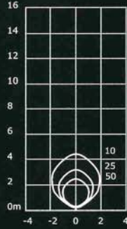
100 watt Mini White Son 24° Beam GX12.1 5000 Lumens I-Max = 14580 cd
