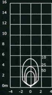
100 watt Mini White Son 12° Beam GX12.1 5000 Lumens I-Max = 65270 cd
